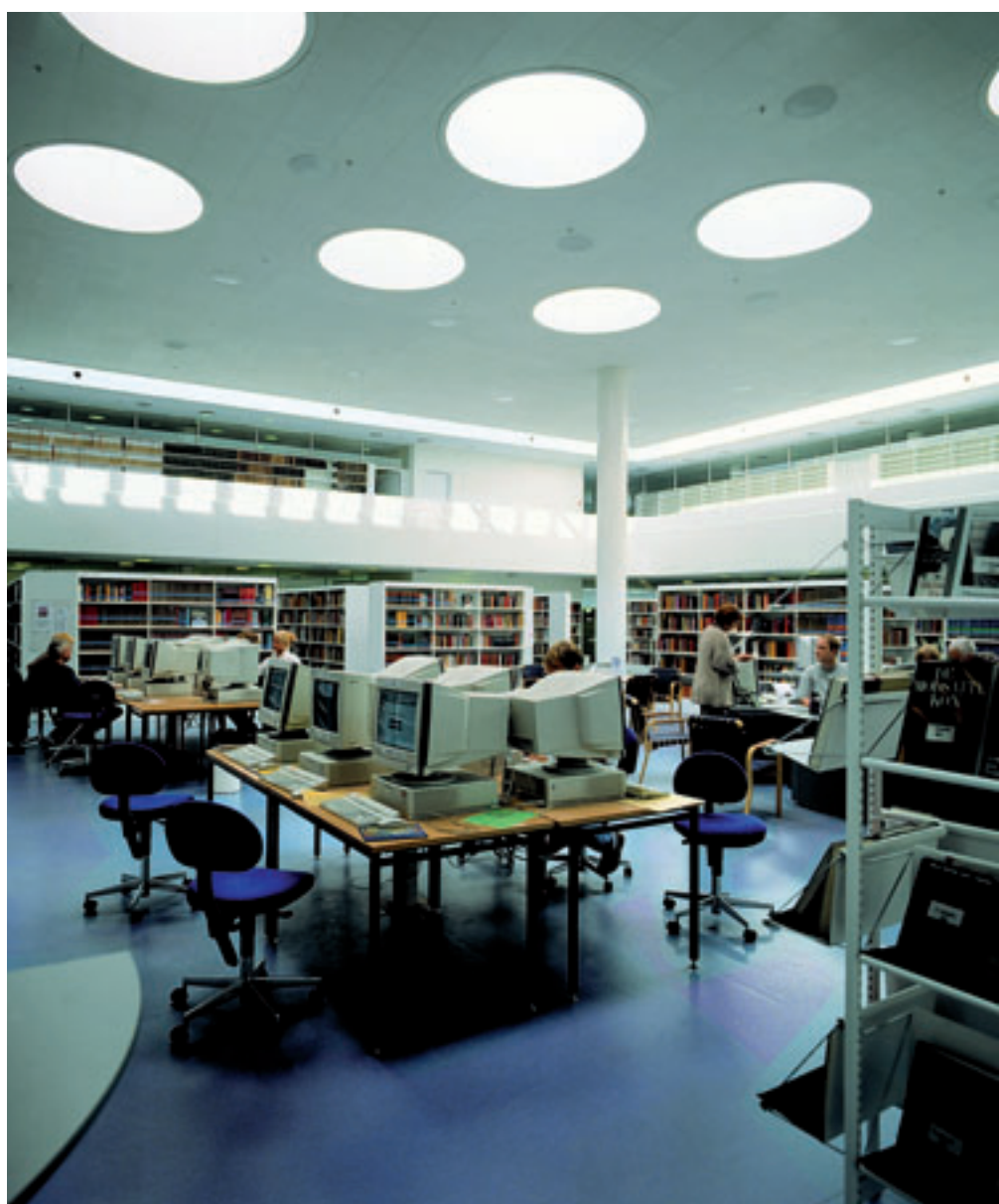
Bygninger med store, dybe rum kan være vanskelige at forsyne med tilstrækkelig dagslys i midten. Løsningen kan være at være at anvende almindelige vinduer i facaden suppleret med ovenlys. Foto: Kjærgaard
