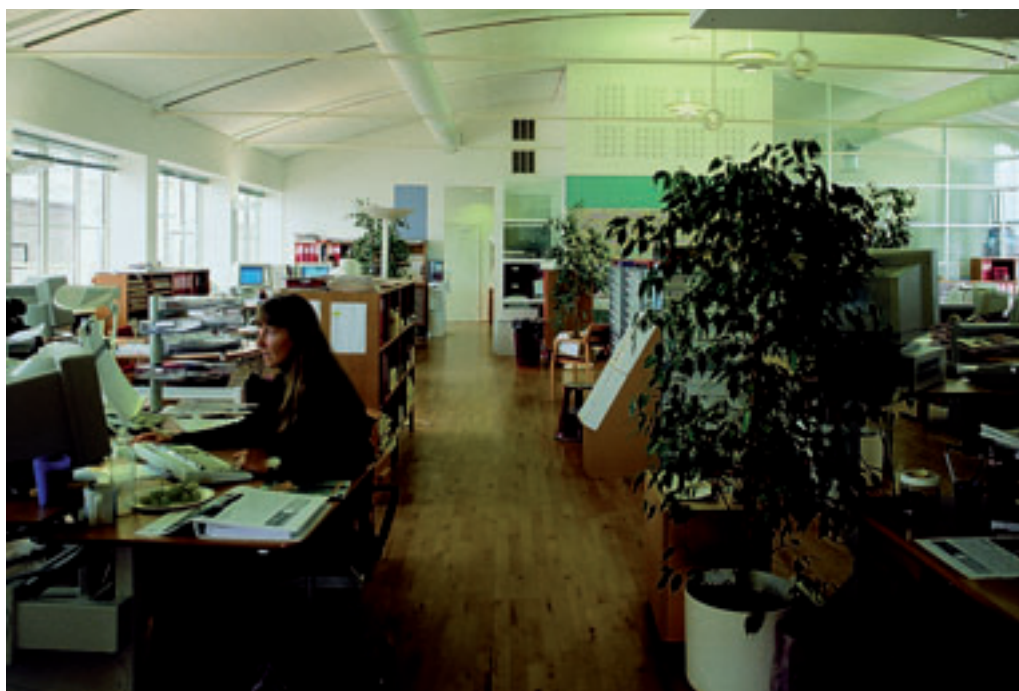
Sukkertoppen: I forbindelse med gennemlyste rum og rum med vinduer i flere sider er der grænser for, hvor dybe rummene kan være, hvis der skal være en rimelig dagslysførelse til faste arbejdssteder. Foto: Morten Kjærgaard
